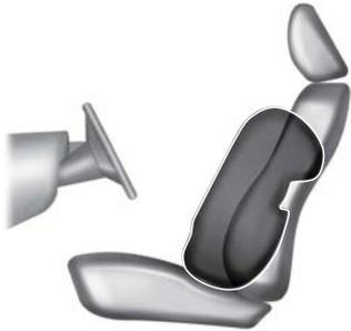
Die Seitenairbags sind so konstruiert, dass sie sich zwischen Türblech und Insassen aufblasen und dadurch den Schutz bei bestimmten Kollisionen erhöhen.
