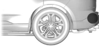
Die Sensoren befinden sich hinter dem Stoßfänger hinten auf beiden Seiten des Fahrzeugs.
