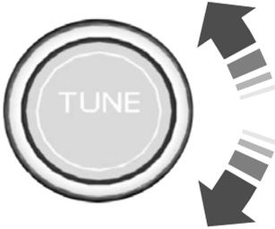
3. Zum Ändern der Frequenz den Regler drehen.
