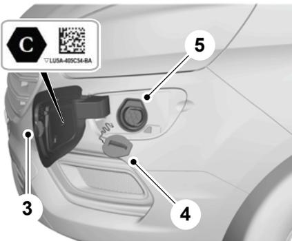
3. Die Ladeanschlussklappe vollständig öffnen.
