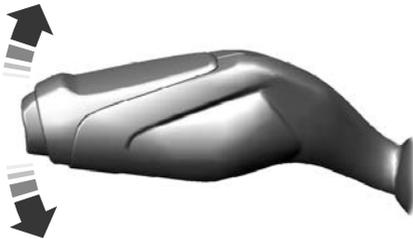
Den Hebel nach oben oder unten drücken, um die Blinkleuchten zu verwenden.
