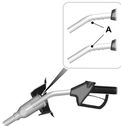
3. Die Zapfpistole bis zur ersten Raste A an der Zapfpistole einführen. Auf der Abdeckung des Tankeinfüllstutzens abgestützt lassen.
