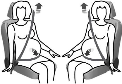
Schwangere Frauen müssen stets den Sicherheitsgurt anlegen. Der Beckengurtteil eines kombinierten Becken- und Schultergurtes sollte unterhalb des Bauchs so tief wie möglich auf das Becken platziert und so straff wie möglich ohne Beeinträchtigung des Komforts angelegt werden. Positionieren Sie den Schultergurtteil über die Mitte von Schulter und Brustkorb.
