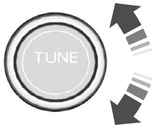
Zum Wechseln des Radiosenders den Regler drehen.
