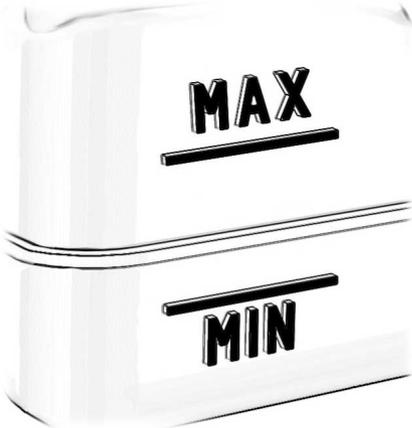
Vergewissern Sie sich, dass sich der Füllstand bei Umgebungslufttemperatur sowohl im Kühlmittelbehälter für den Motor als auch in dem für den Elektromotor zwischen den Markierungen **MIN** und **MAX** befindet. Wenn sich der Kühlmittelstand an oder unter der Mindestmarkierung befindet, sofort Kühlmittel nachfüllen.
