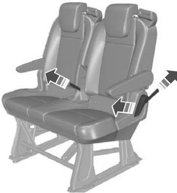
Bei belegtem Sitz den Verstellhebel anheben oder den Riemen ziehen, um die Sitzlehne nach hinten zu neigen.
