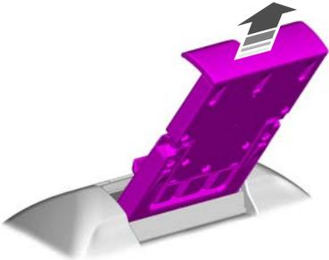
1. Die Gerätehalterung vollständig herausziehen.
