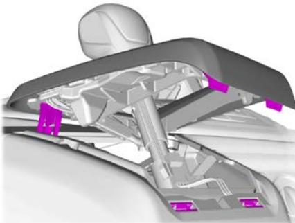
1. Die Verkleidung mit einem Schlitzschraubendreher entfernen.
